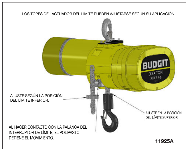
Figura 3-1. Ilustración del interruptor límite
