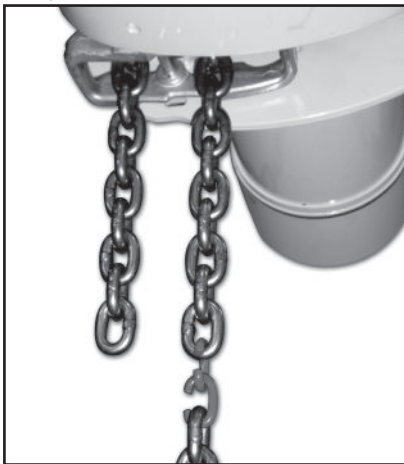
Figura 5-4. Instalación de la cadena de carga común usando dos eslabones en «C» (polipastos de 1/4, 1/2 y 1 tonelada)
