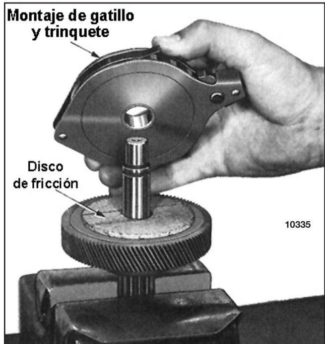
Figura 7-23. Retirar el montaje del trinquete y gatillo del eje del freno de carga
